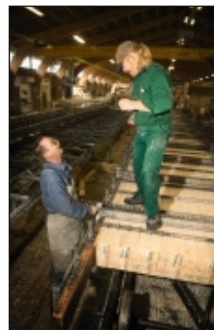
Dyser sørger for, at brædderne får lim på inden de presses sammen til bjælker. Der går 350 g. lim pr. m 2 .
