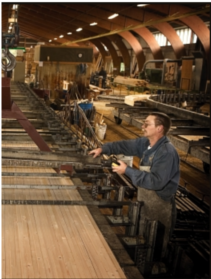
Dyser sørger for, at brædderne får lim på inden de presses sammen til bjælker. Der går 350 g. lim pr. m 2 .
