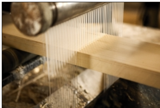
Dyser sørger for, at brædderne får lim på inden de presses sammen til bjælker. Der går 350 g. lim pr. m 2 .
